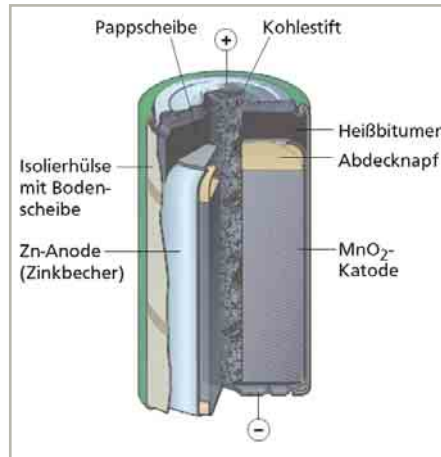
Bild 3: Prinzipieller Aufbau der Zink-Braunstein-Zelle
